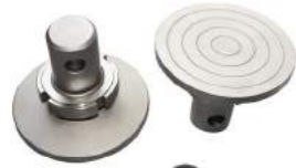
Basma Plakaları Basma testi için plakalar.
