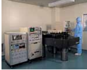
Uzunluk Ölçümü için İyot emme stabilize HeNe (633 nm) lazer
