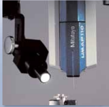
Oto-fokus görüntü sayesinde son derece doğru yükseklik ölçümü.
